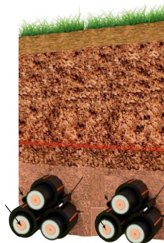
Sous chemin, pistes cyclables, en milieu agricole ou en milieu naturel, les liaisons sont posées en « pleine terre ». Cela permet de limiter les engins de chantiers nécessaires (pas de bétonneuse), de limiter l'impact sur le milieu naturel, mais nécessite l'ouverture d'une fouille sur plusieurs centaines de mètres.
